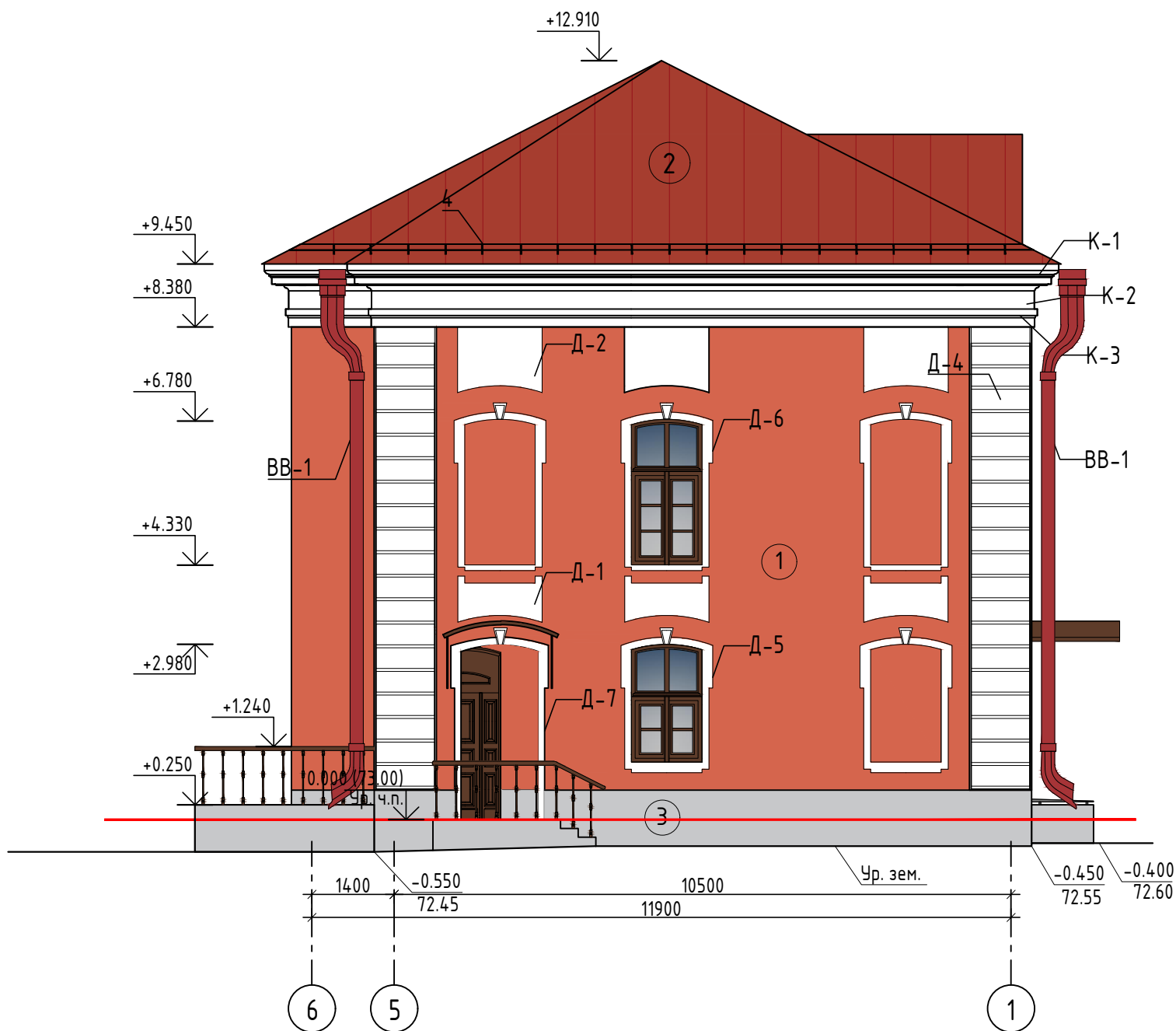
Фасад в осях 6-1
